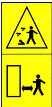
Obr. 2: Nebezpečí zásahu odletujícími úlomky, odřezky, vymrštěnými předměty atp. Ostatní osoby a zvířata - dodržet bezpečnou vzdálenost od stroje.
