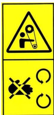
Obr. 3: Nesahej do prostoru klínového řemene
